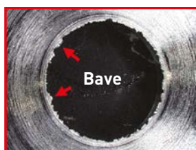
Taglio senza smussatura con sbavature
