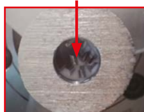
Gambo in acciaio con foro per il refrigerante
