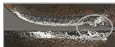
Filo de corte dañado
