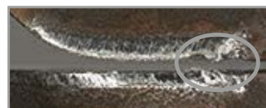
Wykruszenia krawędzi skrawającej
