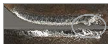
Filo de corte dañado
