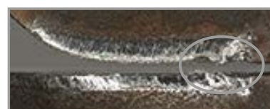
Wykruszenia krawędzi skrawającej
