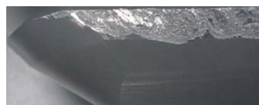
Przykład pęknięcia cieplnego
