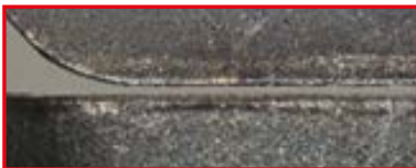
Filo de corte resistente al desgaste al mecanizar acero
