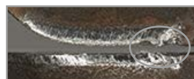
Filo de corte dañado
