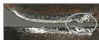
Wykruszenia krawędzi skrawającej
