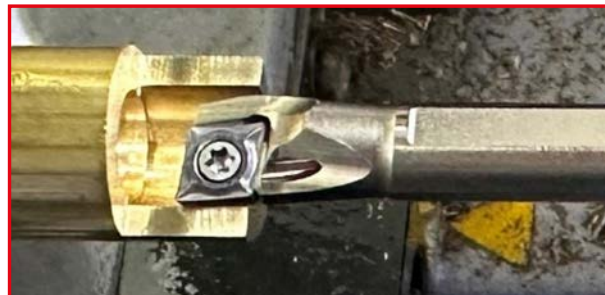
Nóż typu "Dimple Bar" Minimalna średnica skrawania 10 mm
